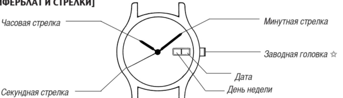
★ Некоторые модели часов, вместо стандартной головки, имеют головку с винтовым фиксатором.
